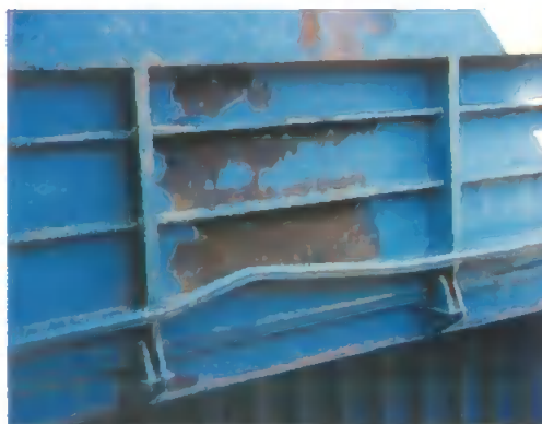
Fig. 5.2 A deformed longitudinal
